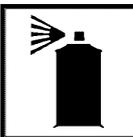
Vor dem Sprühen muss die zu beschichtende Fläche geschliffen, von Staub befreit und entfettet werden. Führen Sie einen Sprühversuch durch. Sprühen Sie die zu schützende Fläche aus 25–30 cm Entfernung gleichmäßig mit dem Produkt ein.
