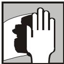
Vor dem Sprühen muss die zu schützende Oberfläche von Staub gereinigt und, wenn möglich, mit dem Entferner APP W900 oder APP WK900 entfettet werden.
