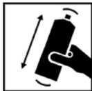
Mischen Sie den Inhalt der Packung gut, indem Sie den Behälter 2–3 Minuten lang schütteln, nachdem die Mischkugeln zu hören sind.
