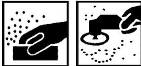
Jegliche Korrosion von rohen Karosserieblechen entfernen. Stahlblech mit Schleifpapier P120-P240 schleifen, verzinkten Stahl, Aluminium und Kunststoff mit Schleifvlies schleifen. Acryl- und Epoxidgrundierungen mit P360-P500 trocken schleifen.
